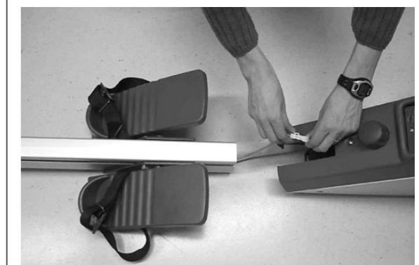
Montez le rail sur le châssis en faisant pénétrer l'étroite plaque métallique sortant du châssis dans la rainure inférieure du rail jusqu'au bout.
