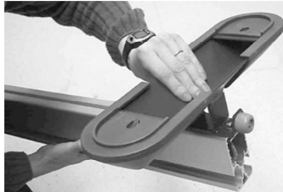
**¡NOTA!** Cuando monte la pata en la parte posterior del raíl, procure que el tope de goma quede hacia delante. Este tope evita que el sillín choque contra la pata al moverse. Cuando la pata esté instalada en la parte posterior del raíl, apriete los dos pernos que la sujetan al bastidor con una llave de tubo de 13 mm.
