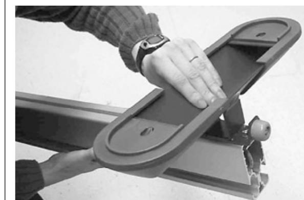
**ACHTUNG!** Das Stützbein hinter den Gummistopper des Rollsets montieren!
