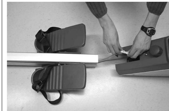
Schuif dan de rail op zijn plaats in het frame, zodat de dunne metalen strip van het frame in de onderste gleuf van de rail past. Schuif de rail tot aan de stopper op het einde van de strip. Let erop dat de sensorkabel nergens afgeklemd wordt! Zet het frame daarna met de beide inbusbouten vast. De inbusbouten worden op hun beurt vastgezet met de moeren en aangedraaid met de ringsleutel.
