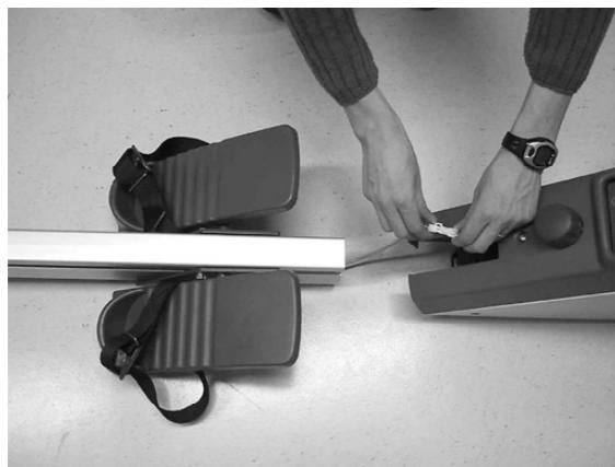
Das Längsprofil so in den Rahmen schieben, daß das schmale Eisen am Rahmen in die untere Nut des Längsprofils gelangt. Das Längsprofil bis zum Anschlag in den Rahmen hineinschieben.
