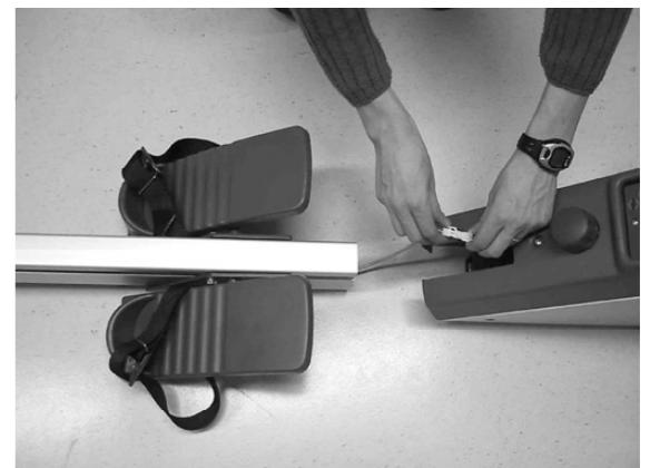
Encage el raíl en el bastidor de modo que la tira metálica fina que lleva el bastidor encaje en el carril de la parte inferior del raíl. Empuje el raíl hasta que toque el tope que hay al final de la tira.
