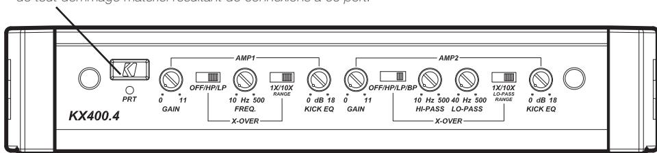
**Sélection de démarrage automatique :** La série KX offre trois modes de démarrage automatique différents qui peuvent être sélectionnés sur le panneau d'extrémité : + 12 V, décalage en c.c. et audio. L'utilisation en mode de décalage c.c. ou audio permet à la terminaison REM de disposer de + 12 V en sortie pour des amplificateurs additionnels.
