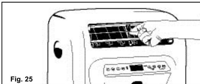
5. Pour régler la direction du débit d'air (haut / bas seulement), régler les **lamelles horizontales** du centre et les autres lamelles seront automatiquement réglées à la même position. **Fig. 25.**
