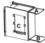
Les bornes de l'imperméable sont installées aux positions "A" et "B", les ouvertures de ventilation vers le bas (C).
