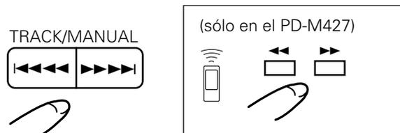
Mientras se mantiene pulsado el botón ▶▶▶▶, la reproducción avanza rápidamente hasta el final del disco. Cuando la reproducción llegue al final del disco, el reproductor entra en el modo de pausa y se visualiza la palabra “END”. Mientras se mantiene pulsado el botón ◀◀◀◀, la reproducción retrocede rápidamente hasta el comienzo del disco.
