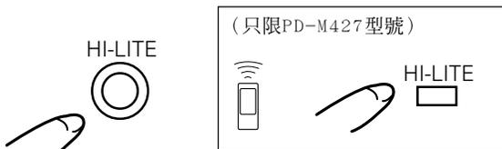
當在停止狀態下按一次HI-LITE按鈕時，唱機將從第一首曲子曲首後面1分鐘的位置起開始放音，每張唱碟上的第一首曲子都被播放10秒鐘左右。在唱碟掃描方式中DISC SCAN指示器點亮。所有唱碟上的第一首曲子被掃描後，唱機進入停止狀態。當在停止狀態下按兩次HI-LITE按鈕時，唱機將從曲首後面1分鐘的位置起開始放音，每個曲子都被播放10秒鐘左右。在曲子掃描方式中SCAN指示器點亮。所有唱碟上的全部曲子被掃描後，唱機進入停止狀態。
