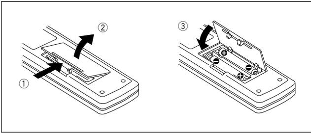
Abra la tapa del compartimiento de las pilas, situado en la parte posterior de la unidad de control remoto, e inserte las pilas (tamaño "AAA" (IEC R03)), asegurándose de alinear correctamente las polaridades  $\oplus$  y  $\ominus$ .
