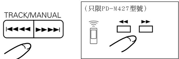
當▶▶▶▶| 按鈕被按著不放時，放音位置將迅速進到該唱碟的尾端。當放音位置達到唱碟的尾端時，鐳射唱機將進入暫停狀態並顯示出“END”。當|◀◀◀◀ 按鈕被按著不放時，放音位置將迅速退到該唱碟的開頭。當找到所需的曲段時，放開▶▶▶▶| 或|◀◀◀◀ 按鈕則唱機就在▶▶▶▶| 或|◀◀◀◀ 按鈕被放開時的位置起進入正常方式(放音或暫停)。
