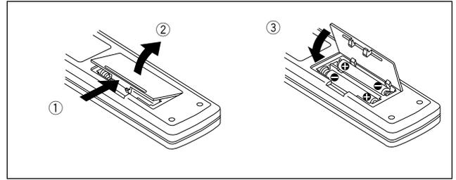
打開遙控器後面電池艙蓋子，並放入電池（尺寸'AAA'（IEC R03）），注意正確調好（⊕）與（⊖）極性。
