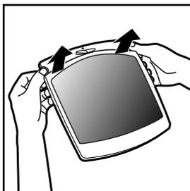
2. Retirer le sac en plastique du filtre avant de l'installer. Placer ce dernier dans l'épurateur d'air, de telle sorte que le coin échancré du filtre épouse le bord échancré de l'épurateur d'air.
