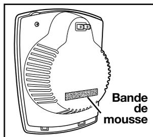
Bande de mousse pour maintenir la bonne position et pour un fonctionnement silencieux. Ne pas enlever. Composer le numéro d'appel sans frais du service à la clientèle pour obtenir un remplacement.
