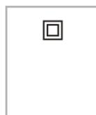
Ce symbole indique que l'appareil est doté d'un double système d'isolation entre la tension section dangereuse et les pièces accessibles à l'utilisateur. Lors de l'entretien, utiliser exclusivement des pièces de rechange identiques.
