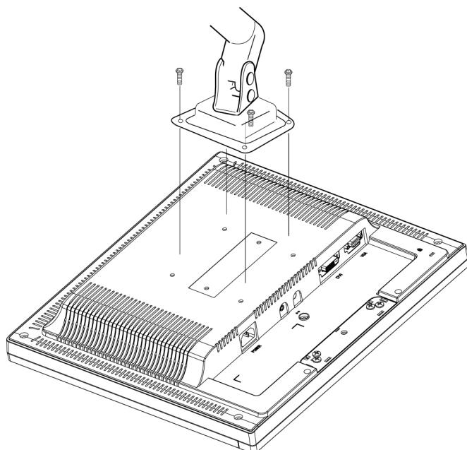
Siga estas etapas para terminar de instalar o braço de montagem de parede:
