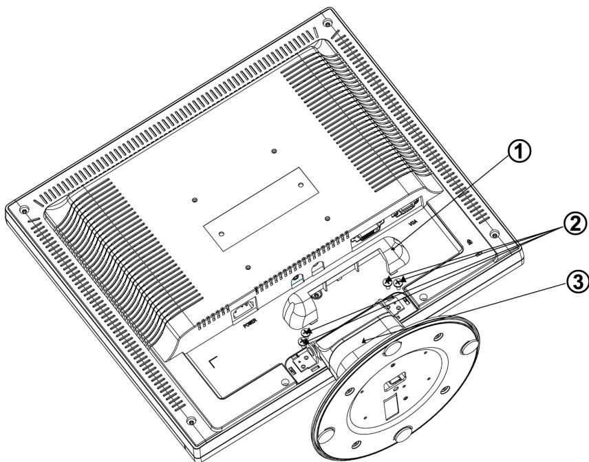
Este monitor puede ser colocado en un brazo de montaje de pared adquirido por separado. Apague y luego desconecte los cables del monitor antes de realizar el procedimiento que aparece más adelante. Coloque el monitor hacia abajo sobre una superficie suave.
