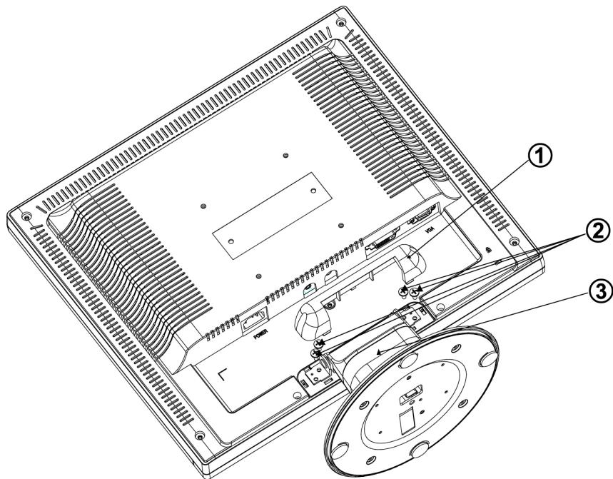
Cet écran peut être fixé sur un support mural, à acheter séparément. Mettre l'écran hors tension puis débrancher les câbles de l'écran, avant de suivre la procédure ci-dessous. Déposer l'écran, avec la face posée contre une surface douce.
