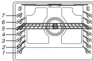
Le four possède 7 positions pour grille plate, comme indiqué dans l'illustration précédente et le tableau suivant.
