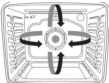
Durant la cuisson ou le rôtissage par convection, les éléments de cuisson au four, cuisson au gril et de convection s'allument et s'éteignent par intermittence tandis que le ventilateur fait circuler l'air chaud. Durant la cuisson au gril par convection, les éléments de cuisson au gril et de convection s'allument et s'éteignent par intermittence.
