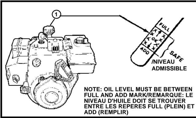
① OIL FILL CAP/DIPSTICK/BOUCHON DE REMPLISSAGE/JAUGE DE NIVEAU D'HUILE
