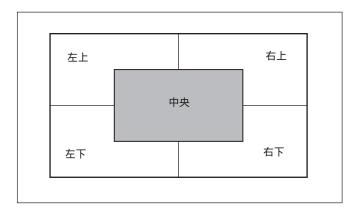
本機に電源を投入した最初にMAGボタンを押したときは、中央が 自動選択されます。カメラの出力信号には影響しません。
