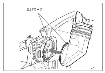
**2** VF 筒部の合いマークを本体の合いマークに合わせながら、 VF 筒部を本体へ差しこむ。
