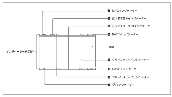
● MAG(拡大表示)インジケーター 前面パネルのMAGボタン (6(J)ページ)を押して画像を拡大表示 したときに点灯します。
