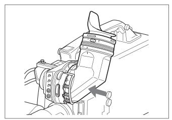
3 リリースつまみがカチッと音を立てるまでVF筒部を時計方向に回す。
