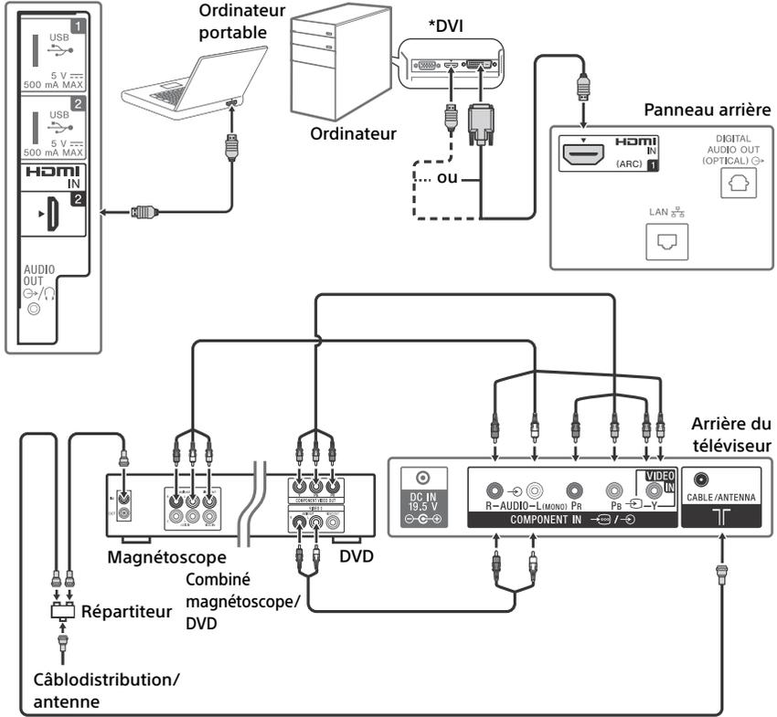
\* La prise DVI ne prend pas en charge les signaux audio. Connecter la sortie audio de l'ordinateur aux enceintes d'ordinateur ou à un récepteur audio-vidéo pour écouter le son de l'ordinateur.
