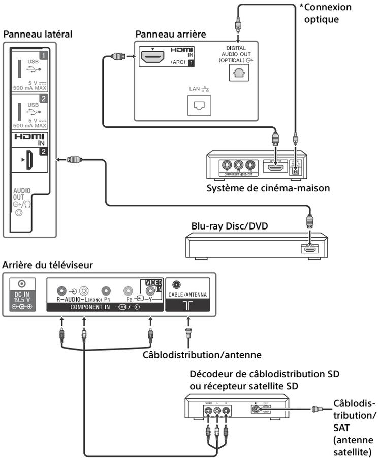
\* La connexion optique est requise seulement lorsque le système de cinéma-maison n'est pas compatible ARC (Audio Return Channel) et qu'il est connecté en HDMI.
