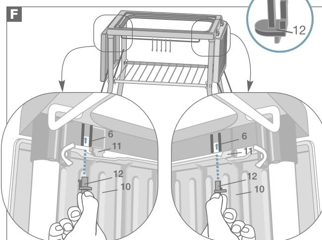
An jeder abklappbaren Abstellfläche (10) das vordere Scharnier blockieren, indem Sie einen Verschlußclip (12) einführen. Dieser Verschlußclip ist zwischen den beiden Führungsnuten unter dem Rand des Stützrahmens (6) anzubringen.
