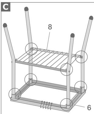
Wiederholen Sie den Schritt B mit der gegenüberliegenden Ecke des Abstellrosts (8), um ihn horizontal zu stabilisieren.
