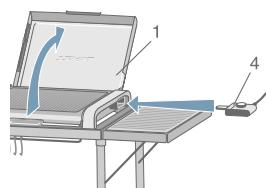
Clipper la bêquille de verrouillage (14) du couvercle (1). Insérer à fond le boîtier de commande (4) dans l'appareil puis brancher le cordon sur le secteur : le voyant s'allume.
