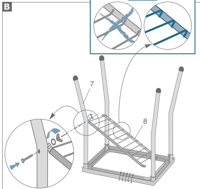
Führen Sie von der Außenseite eine Schraube in ein Standbein (7) ein und befestigen Sie mit Hilfe einer Flügelmutter die Ecke des Abstellrostes (8).
