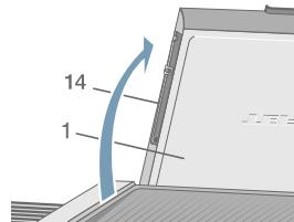
Nehmen Sie die Grillabdeckung (1) von dem Gerät ab. Öffnen Sie sie dazu halb und heben Sie sie dann nach hinten ab.
