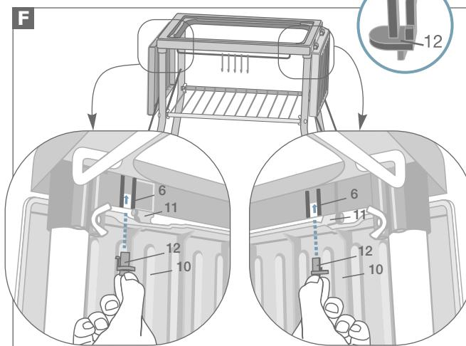
Pour chaque plateau rabattable (10), bloquer la charnière avant en insérant un clip de verrouillage (12). Le positionner entre les deux rainures de guidage prévues à cet effet sous le rebord du cadre support (6).
