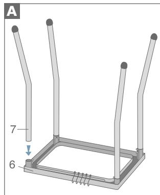
Legen Sie den Stützrahmen (6) umgedreht auf eine ebene und stabile Fläche.
