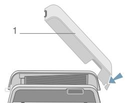
Coloque la tapa de protección (1) detrás del aparato, tal como se muestra en el dibujo.
