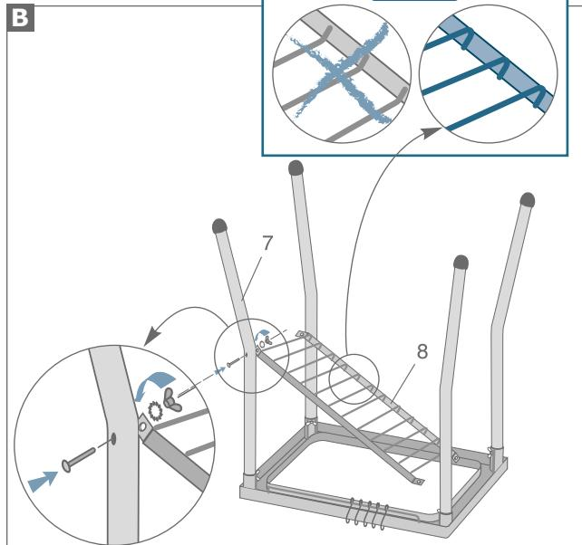
Inserte un tornillo en un pie (7), por la parte exterior, y luego añada una arandela y fije con una tuerca mariposa, integrando una esquina de la rejilla estante (8).
