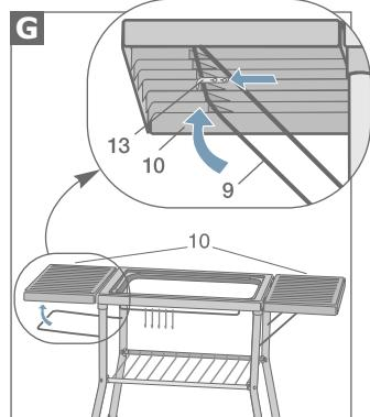
Pour mettre les plateaux rabattables (10) en position horizontale, soulever un plateau, puis enclencher sous celui-ci le fil support (9) dans le logement prévu à cet effet.
