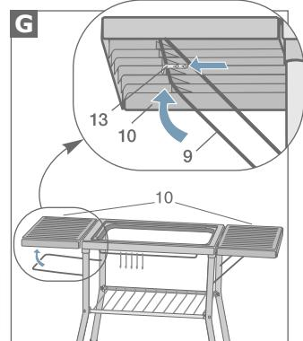
Para colocar las alas abatibles (10) en posición horizontal, levante una bandeja y encave la varilla soporte debajo de ésta (9) en el compartimento previsto a este efecto.
