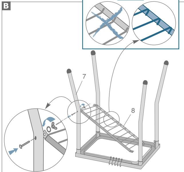
Insérer une vis dans un pied (7), par l'extérieur, puis ajouter une rondelle et visser à l'aide d'un écrou papillon, en intégrant un angle de la grille de rangement (8).
