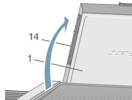
Retire la tapa de protección (1) del aparato abriéndola hasta media altura y después levantándola desde detrás del aparato.
