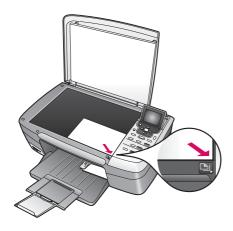
**c** 将照片面朝下放在玻璃板的右前角。确保照片的长 边沿玻璃板前边放置。关闭盖子。
