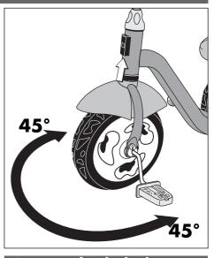
Automatic fixed wheel Automatisme de roue fixée Llanta fija automática
