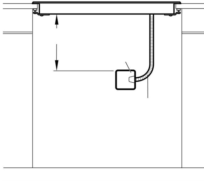
Vous pouvez trouver la plaque signalétique comportant les spécifications électriques sur le dessous de l'appareil. La boîte de jonction doit être placée à 3 pi (91,4 cm) du raccord de connexion de la table de cuisson. On doit pouvoir y accéder facilement aux fins de l'entretien.
