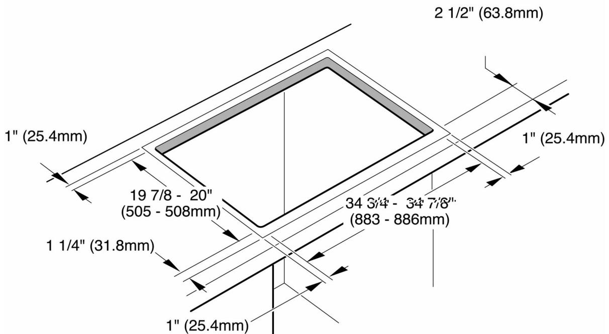
Después de preparar el hueco, retire las virutas, ya que pueden afectar el funcionamiento de los componentes eléctricos.
