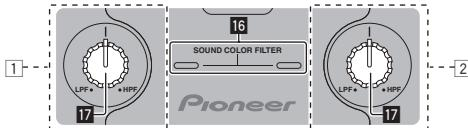
Cada canal está equipado con una función SOUND COLOR FILTER por la cual pueden obtenerse efectos de filtro girando simplemente un control grande.
