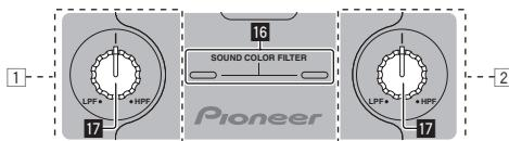
每聲道皆配備 SOUND COLOR FILTER 功能，轉動大型控制鍵即可輕易達到濾波器音效。
