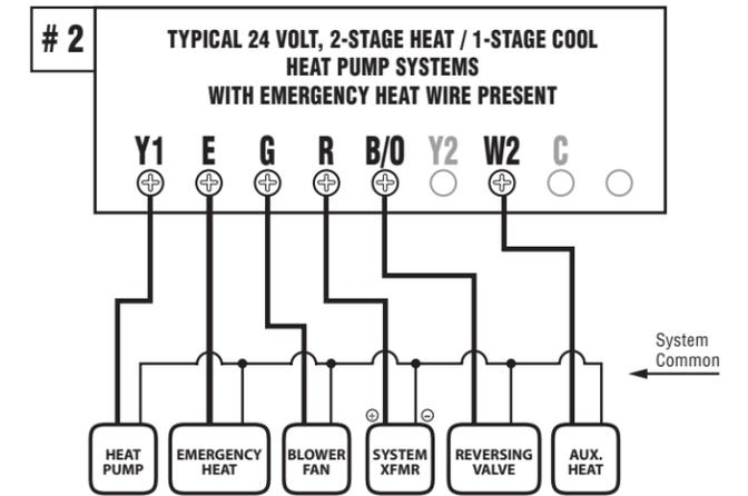
(DHP2120) FRENCH - SCHÉMAS D'IDENTIFICATION DES FILS ET DU CÂBLAGE
