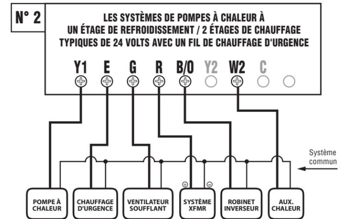
(DHP2120) - IDENTIFICACIÓN DE CABLES Y DIAGRAMAS DE CABLEADO
