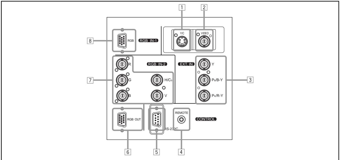
**1 Y/C (S video) input terminal (Mini DIN 4 pin)**
