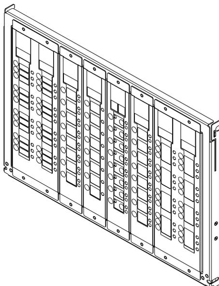
**Figure 2-11. LED/Switch Modules**
