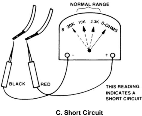
**Figure C-1. Volt/Ohm Meter Readings**
