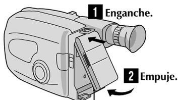
BATT. RELEASE (extracción de la batería)
