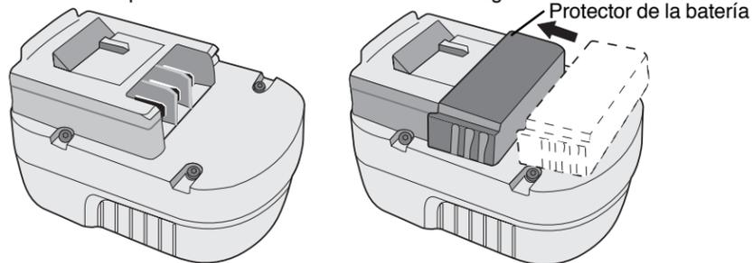
⚠ **ADVERTENCIA:** Asegúrese de que las terminales de la batería no entren en contacto con metales. Por ejemplo, no coloque la batería en un delantal, bolsillos, cajas de herramientas, estuches del producto, cajones etc. sin antes colocarle la tapa. Sin la tapa, la batería puede entrar en corto circuito causando incendio o quemadura a la batería.
