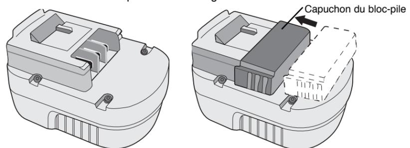
**⚠ AVERTISSEMENT :** s'assurer, au moment de ranger ou de transporter le bloc-pile, qu'aucun objet métallique n'entre en contact avec les bornes à découvert du bloc-pile. Par exemple, il faut éviter de placer un bloc-pile sans capuchon dans un tablier, une poche, une boîte à outils ou un tiroir (etc.) contenant des objets tels que des clous, des vis ou des clés, car le bloc-pile pourrait causer un court-circuit et s'endommager, ou risquer de provoquer des brûlures ou un incendie.
