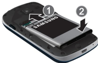
4. Presione levemente el extremo inferior de la batería (2) hacia abajo y adentro del teléfono, hasta que se acomode en su lugar.
