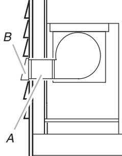
A. Conduit de dia. 6" (15,2 cm) pour sortie à travers le mur
