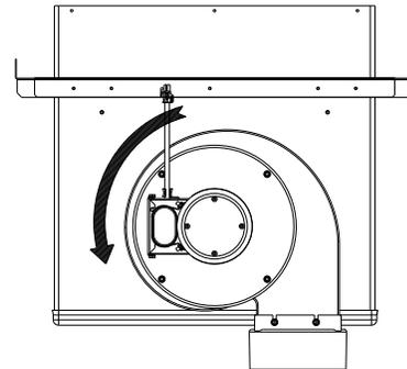
5. Resserrer chaque écrou à l'aide de la douille de  $\frac{3}{8}$ ", de la rallonge et de la clé à cliquet.
