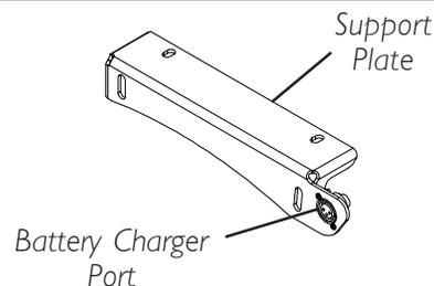
**FIGURE 7 - CHARGING BATTERIES**
