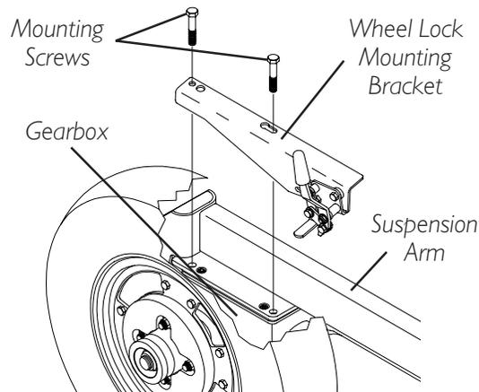
**FIGURE 5 - INSTALLING WHEEL LOCK BRACKET ONTO WHEELCHAIR**
