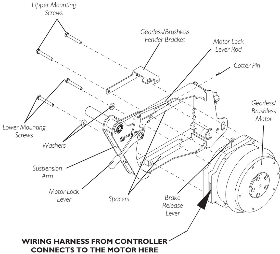
**FIGURE 11 - REMOVING/INSTALLING THE MOTOR - HEAVY-DUTY GEARLESS/BRUSHLESS MOTOR**
