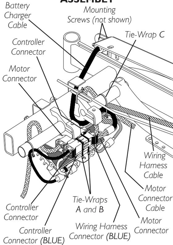
**DETAIL "C" - WHEELCHAIRS WITH GEARLESS/BRUSHLESS MOTOR**
