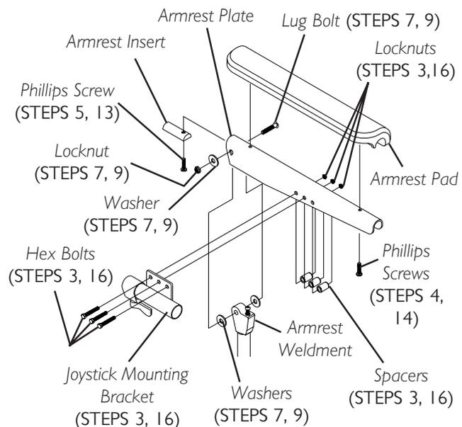
**FIGURE I - REPOSITIONING MKIV JOYSTICK - VAN SEAT MODELS**
