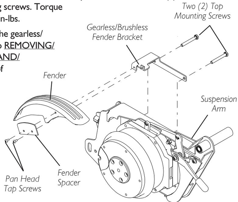
**FIGURE 14 - INSTALLING/REMOVING FENDERS - HEAVY DUTY GEARLESS/BRUSHLESS MOTORS**
