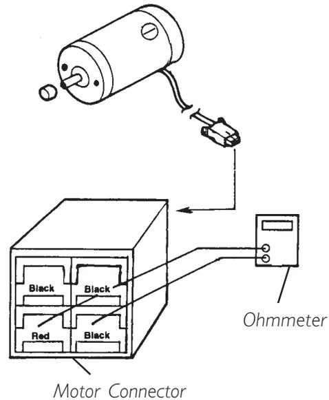
**FIGURE 2 - MOTOR TESTING**
