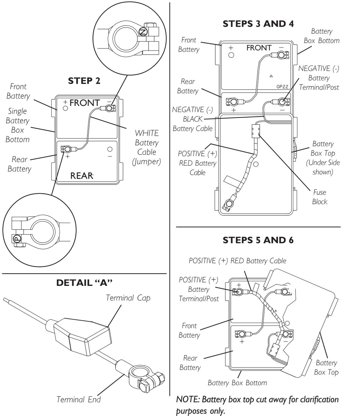
**FIGURE 5 - CONNECTING BATTERY CABLES - SINGLE 22NF BATTERY BOX**
