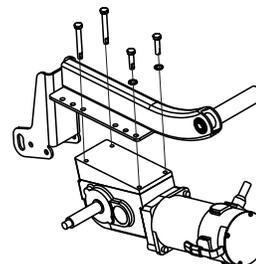
**FIGURE 11 - REPOSITIONING THE MOTOR - REPOSITIONING THE MOTOR/GEARBOX**
