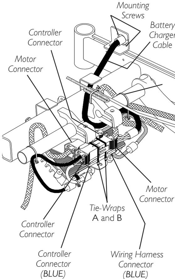
**DETAIL "C" - WHEELCHAIRS WITH GEARLESS/BRUSHLESS MOTOR**
