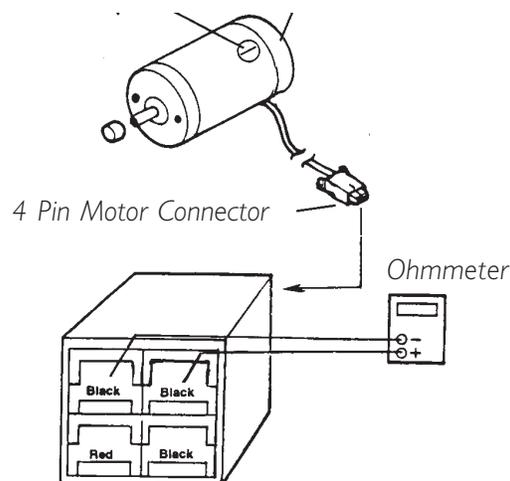
**FIGURE 4 - ELECTRO-MECHANICAL PARKING BRAKE TESTING**
