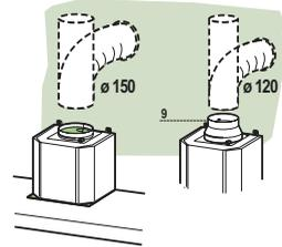
**⚠ Achtung! Alle Querschnittänderungen oder Richtungsänderungen des Abluftkanals reduzieren die Leistung der Haube.**
