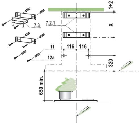
**⚠ Achtung:** Bitte beachten Sie bei der Montage das Gewicht der kompletten Haube. Die Tragfähigkeit der Decke oder alternativ der Trägerplatte für diese Zugbelastung muss vor der Montage geprüft und gegebenenfalls durch die Anbringung von geeigneten Befestigungs- oder Stabilisierungselementen hergestellt werden. Kann eine hinreichende Tragfähigkeit nicht sichergestellt werden, ist von einer Montage abzusehen.
