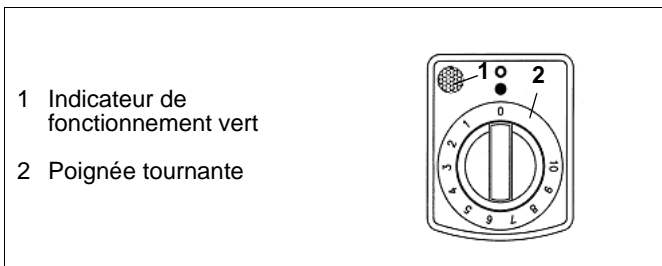
Fig.11 Poignée et indicateur de fonctionnement
