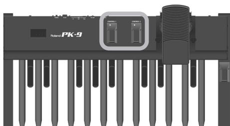
De PK-9 bevindt zich nu in de parametermode. De afkorting van de eerste parameter (of van de parameter, die na het inschakelen het laatst werd gekozen) knippert.
