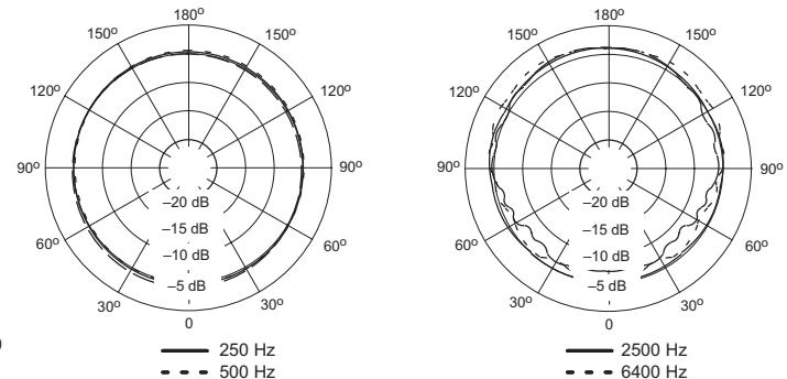
OMNIDIRECTIONAL • OMNIDIRECTIONNELLE • KUGEL
