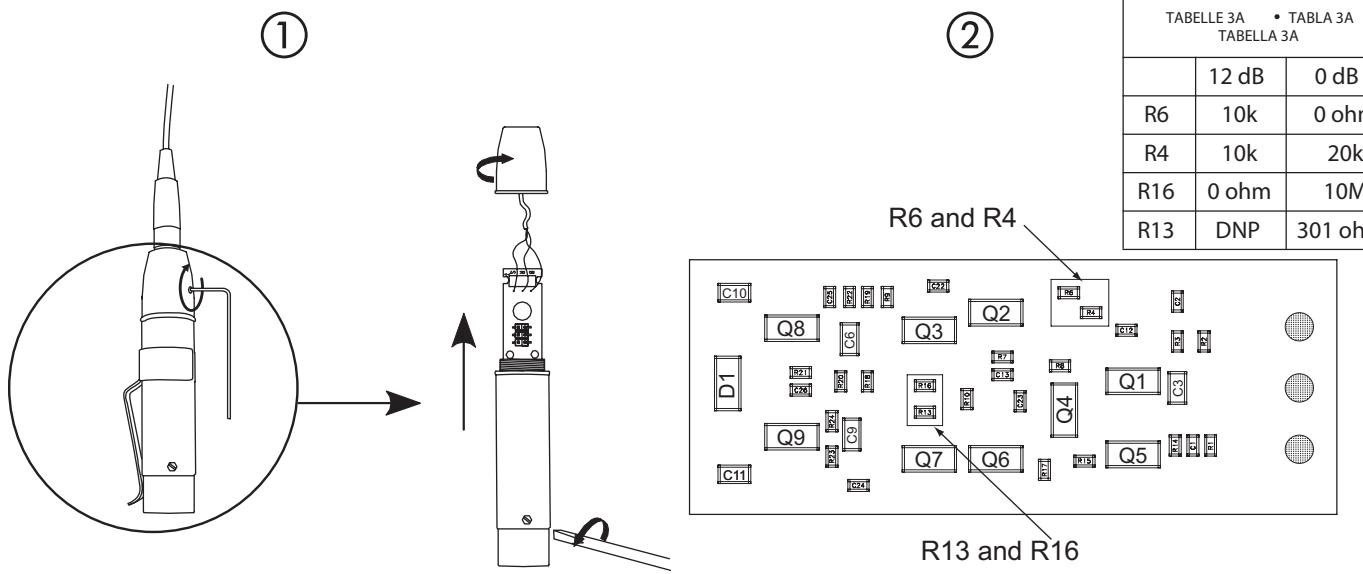
PREAMP GAIN ADJUSTMENT • RÉGLAGE DE PRÉAMPLI • VORVERSTÄRKERVERSTÄRKUNGSEINSTELLUNG • AJUSTE DE GANANCIA DEL PREAMPLIFICACIÓN • REGISTRAZIONE DI GUADAGNO DELLA PREAMPLIFICAZIONE
