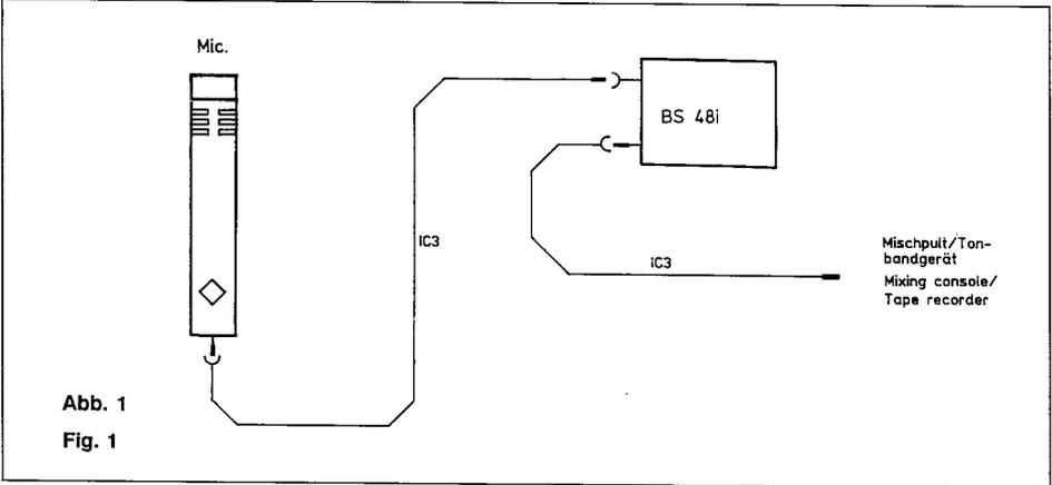
**2.5 BS 48 i-2: Steckverbinder, Steckerbelegung und Anschlußkabel**
