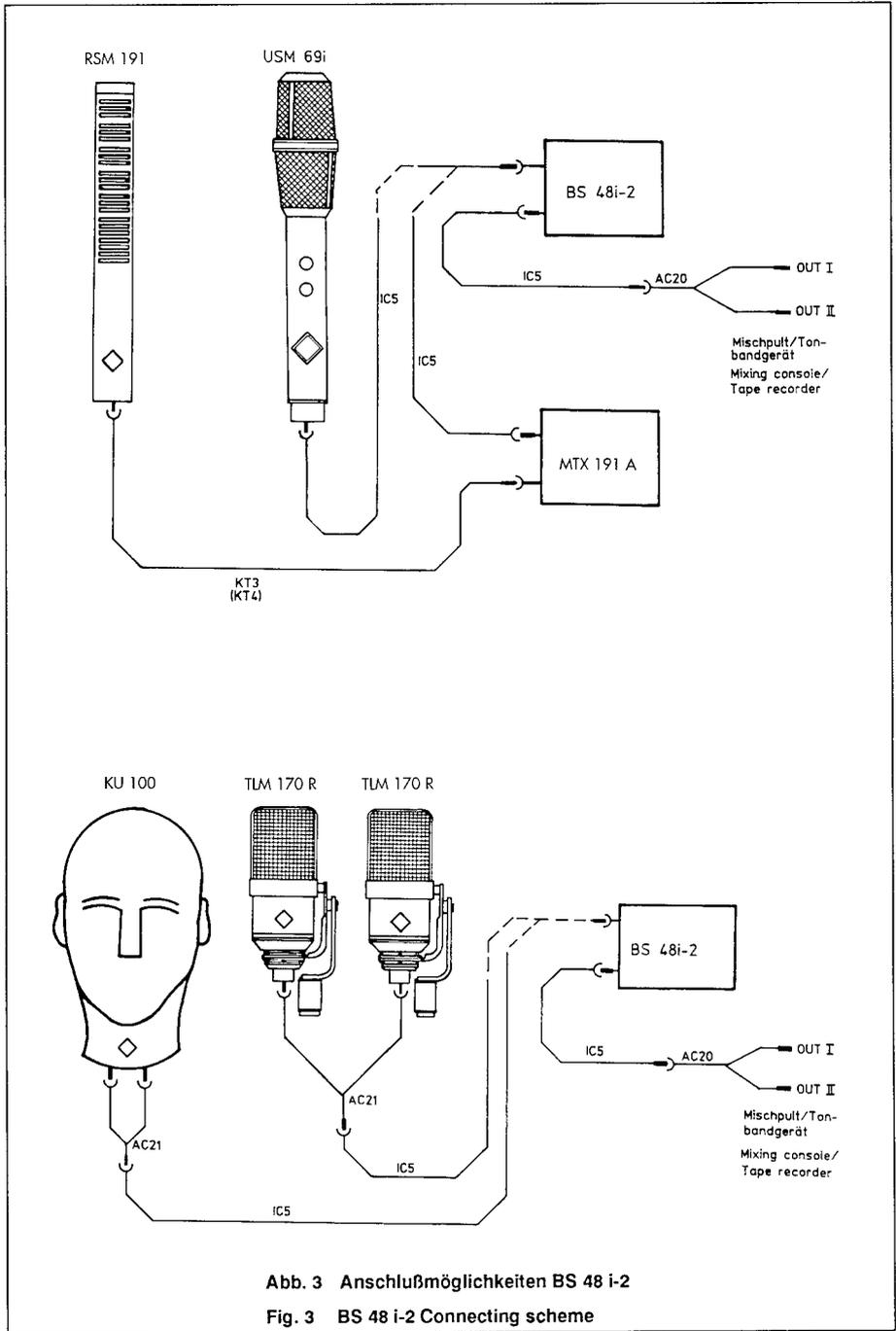
Abb. 3 Anschlußmöglichkeiten BS 48 i-2
