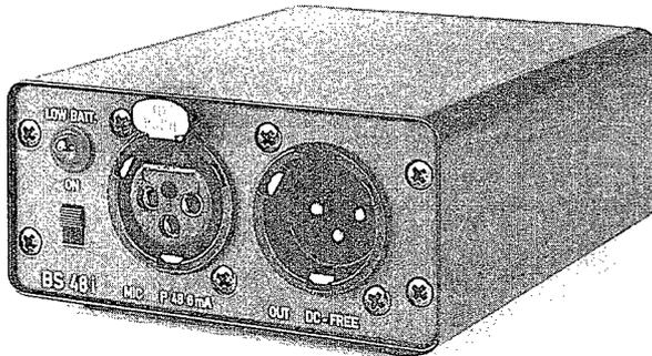
Das Batteriespeisegerät BS 48 i besitzt zwei 3polige XLR-Steckverbinder und ist zur Stromversorgung eines Kondensatormikrophons mit  $48\text{ V} \pm 4\text{ V}$ , max. 5 mA nach DIN EN 61938/IEC 1938 geeignet.
