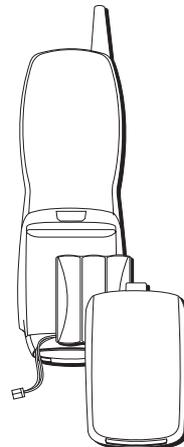
**NOTA:** Si el paquete de las baterías no está instalado en el auricular, o conectado adecuadamente dentro del compartimiento, la pantalla así lo indicará (“NO BATERIA“) cuando se coloca el auricular sobre la base.
