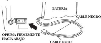
**NOTA:** Es importante mantener la polaridad (los cables rojo y negro) en el enchufe dentro del compartimiento como se muestra en la ilustración.
