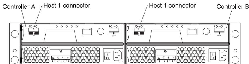
Figure 31. DS3200 controller connectors
