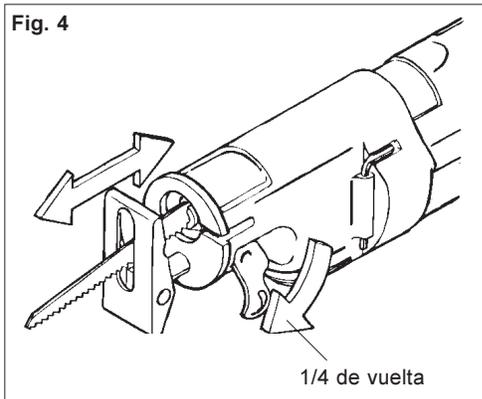
1. Para ajustar la zapata, jale hacia abajo 1/4 de vuelta el seguro de la misma y deslicela hacia adelante o atrás, a la posición deseada.
