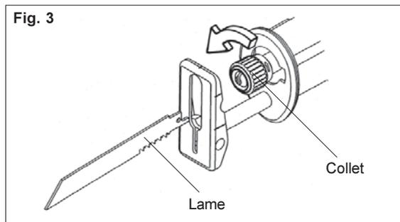
1. Selon la tâche à accomplir, la lame peut être installée avec les dents vers le haut ou vers le bas. Pour installer une lame, tournez le collet dans le sens de la flèche et introduisez la lame dans la fixation jusqu'à ce que le tenon s'arrête sur le collet.
