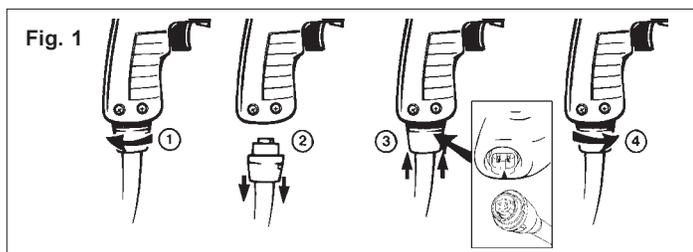
1. Para desmontar el cable Quik-Lok®, gire el cable 1/4 de vuelta hacia la izquierda y sepárelo del cuerpo de la unidad.
