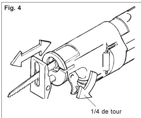
1. Pour ajuster la semelle, abaissez le levier déclencheur de la semelle d'un quart (1/4) de tour vers le bas et glissez la semelle vers l'avant ou l'arrière selon la position désirée.
