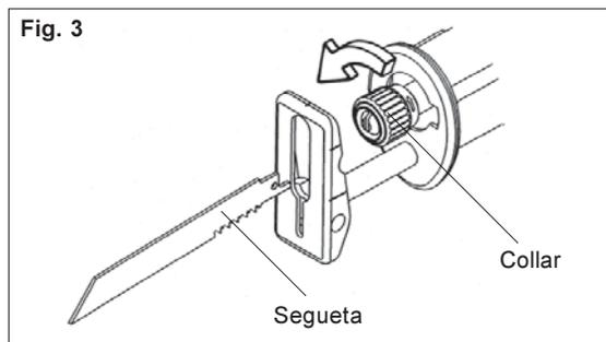
1. Dependiendo del trabajo a realizar, usted podrá colocar la sequeta con los dientes hacia abajo o hacia arriba. Para instalar la sequeta, gire el collar en el sentido del símbolo de la flecha mientras inserte la sequeta en la abrazadera hasta que el zanco llegue al collar.
