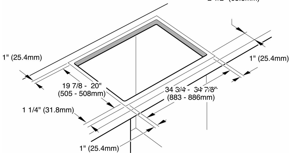
Después de preparar el hueco, retire las virutas, ya que pueden afectar el funcionamiento de los componentes eléctricos.
