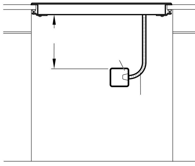
Vous pouvez trouver la plaque signalétique comportant les spécifications électriques sur le dessous de l'appareil. La boîte de jonction doit être placée à 3 pi (91,4 cm) du raccord de connexion de la table de cuisson. On doit pouvoir y accéder facilement aux fins de l'entretien.
