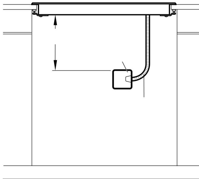
Puede encontrar la placa de identificación con las especificaciones eléctricas en la parte inferior del electrodoméstico. La caja de empalme debe estar ubicada dentro de los 3 pies de la conexión de la placa. Se debe poder acceder a ella fácilmente para realizar las reparaciones.
