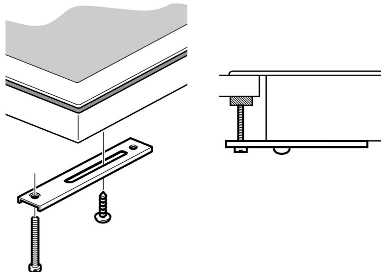
La table de cuisson doit être fixée fermement au plan de travail au moyen des supports de fixation fournis.
