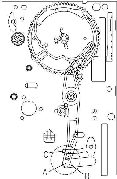
Fig.3-12 ASSEMBLY OF THE CAM GEAR & RELAY LEVER
