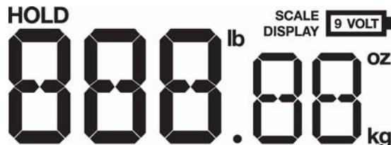
Gracias a esta unidad de exhibición remota, el aparato no posee cable que conecte la plataforma con el visor. Este visor de exhibición remota debe colocarse a unos 15 pies (4.5 metros) de la plataforma de modo que ambas unidades puedan comunicar entre ellas mediante señales radiales.
