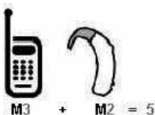
En el ejemplo antes señalado, si un aparato para sordera cumple con la clasificación de nivel M2 y el teléfono inalámbrico cumple la clasificación de nivel M3, la suma de los dos valores es igual a M5. Esto debería proporcionar al usuario del aparato para sordera un "uno normal" al usar su dispositivo auditivo con ese teléfono inalámbrico en particular. "Uso normal" en este contexto se define como una calidad de señal que es aceptable para el funcionamiento normal.
