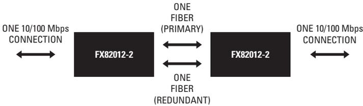
**POINT-TO-POINT APPLICATION WITH FIBER REDUNDANCY**
