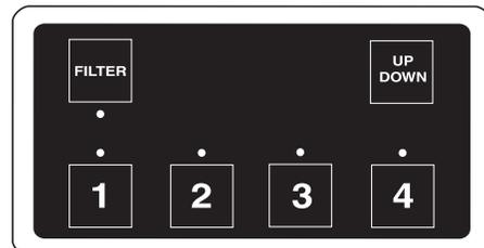
**VITESSES DU VENTILATEUR** Le ventilateur comporte 4 réglages de vitesse différents. Appuyez UNE FOIS pour mettre le ventilateur en MARCHÉ à la vitesse désirée. Appuyez ENCORE sur le bouton pour ARRÊTER le ventilateur.
