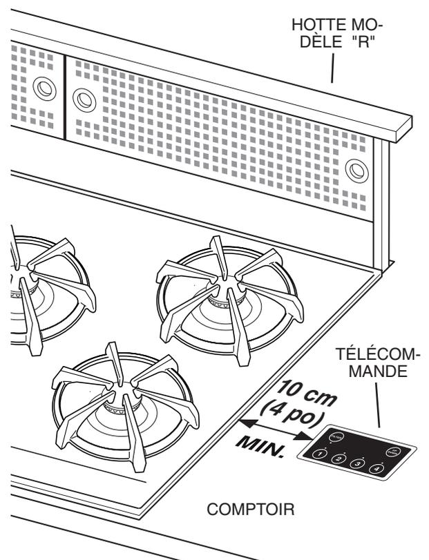
**Remarque :** La télécommande doit être montée dans le **comptoir** à au moins 10 cm (4 po) de cuisson ou de la gamme bord supérieur
