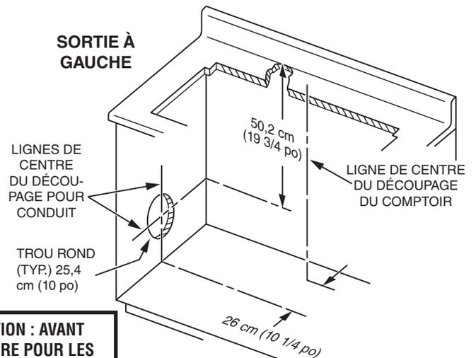
**ATTENTION : AVANT DE DÉCOUPER L'ARMOIRE POUR LES CONDUITS, assurez-vous que les solives du plancher, les montants des murs, les câbles électriques et les tuyaux de nuisent pas.**
