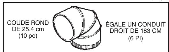
3. L'évacuation est plus efficace lorsque les conduits ne dépassent pas 12 m (40 pi) de longueur ou l'équivalent. L'illustration ci-dessus indique l'équivalent en longueur des coudes et des transitions. La longueur des conduits droits plus l'équivalent pour les coudes et les transitions ne doit pas excéder 12 m (40 pi).
