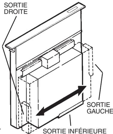
2. Pour un rendement optimal : Choisissez pour les conduits le trajet le plus court possible avec un minimum de coudes et de transitions. Assurez-vous que les solives du plancher, les montants des murs, les câbles électriques et les tuyaux de nuisent pas.
