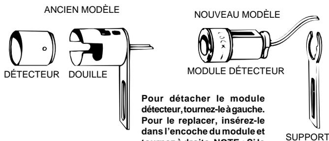
Pour détacher le module détecteur, tournez-le à gauche. Pour le replacer, insérez-le dans l'encoche du module et tournez à droite. NOTE : Si le support est détaché du brûleur, il faut prendre soin de le réinstaller dans le même sens, sans quoi le module ne s'adaptera plus.
