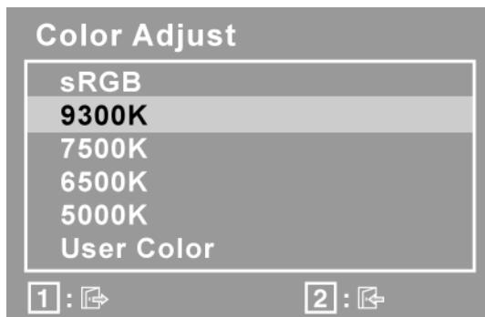
**sRGB** - sRGB wird mehr und mehr zum Industriestandard für die Farbverwaltung. Viele der neuen Anwendungen unterstützen sRGB bereits. Bei Aktivierung dieser Einstellung werden Farben auf der LCD-Anzeige originalgetreuer dargestellt. Die Aktivierung der sRGB-Einstellung führt dazu, dass die Einstellungen für Helligkeit und Kontrast deaktiviert werden.
