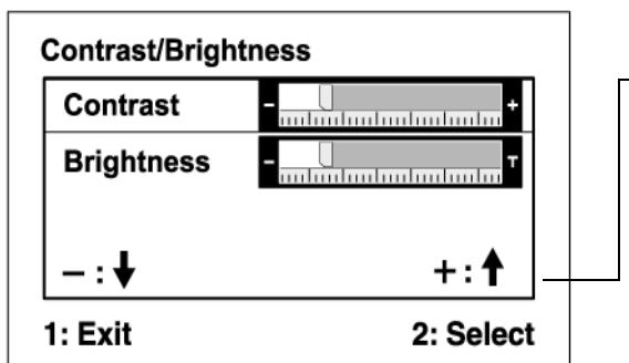
Командная строка в нижней части экрана подсказывает, что дальше делать на экране. Можно выбирать регулировочные экраны, настроить выбранные опции или выйти из экрана.
