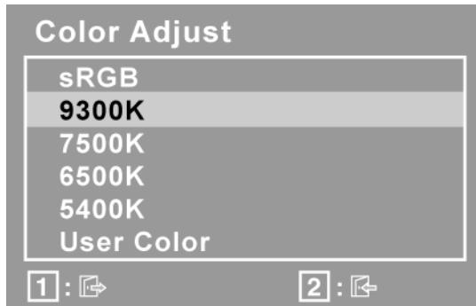
**sRGB-RGB** быстро становится производственным стандартом управления цветом, который поддерживает большинство современных приложений. Эта настройка позволяет более точно отображать цвета на ЖК-дисплее. Включение настройки sRGB делает регулировку контрастности и яркости недоступной.
