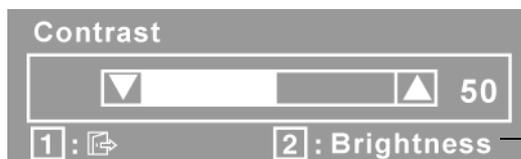
画面下の線はボタン 1 と 2 の現在の機能を示します： **Brightness** (輝度) コントロールを **Exit** (終了) または選択します。
