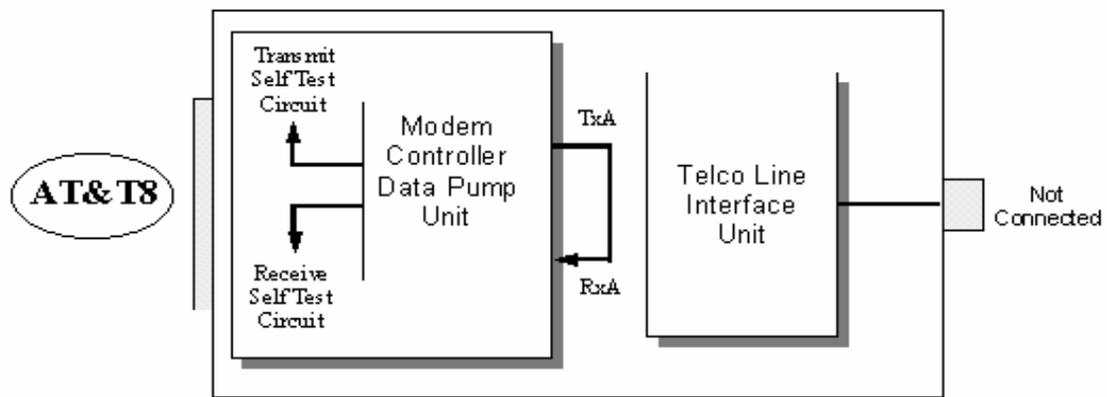
Figure 6 LOCAL ANALOG LOOPBACK WITH SELF TEST
