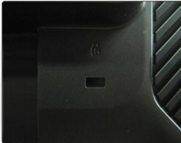
El bloqueo Kensington es un dispositivo que se utiliza para fijar físicamente el sistema cuando se utiliza en un sitio público. (El dispositivo de bloqueo debe adquirirse por separado. )
