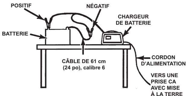
1. Repérez la polarité des bornes de la batterie. La borne positive est marquée des symboles *POS*, *P* ou *+* et la borne négative, des symboles *NEG*, *N* ou *-*. La borne positive est généralement plus grosse que la borne négative.
