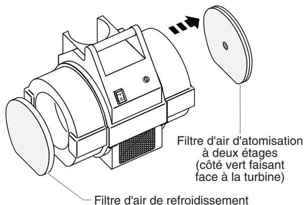
2. Nettoyer les filtres. Donner des petits coups sur les filtres pour évacuer les contaminants ou utiliser de l'air comprimé pour les chasser. Pour les matières qui ne sont pas évacuées facilement, tremper les filtres dans de l'eau savonneuse ou dans de l'essence minérale. Laisser sécher complètement les filtres avant de les remonter dans la turbine.
