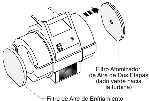
2. Limpie los filtros. Puede sacudir los filtros para sacar los contaminantes o usar aire comprimido para soplear los contaminantes. Para material pegado difícil de separar, sumerja los filtros en agua jabonosa o espíritus minerales. Permita que los filtros se sequen completamente antes de volverlos a colocar en la turbina.
