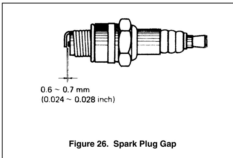
Figure 26. Spark Plug Gap
