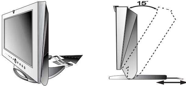
*NOTA: \*Tire de la parte replegable del soporte cuando incline el monitor hacia atrás para lograr más estabilidad. El ángulo máximo de inclinación es de 15 grados en la dirección hacia atrás. No incline el monitor en ángulos no especificados. **Una fuerza excesiva de inclinación puede producir daños permanentes en las partes mecánicas del soporte.***
