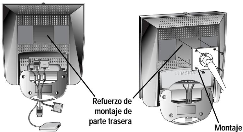
Alinee la base de montaje con los agujeros de la base de la tapa trasera y asegúrela con los cuatro tornillos que vienen con el brazo articulado, la repisa de pared o cualquier otra base.
