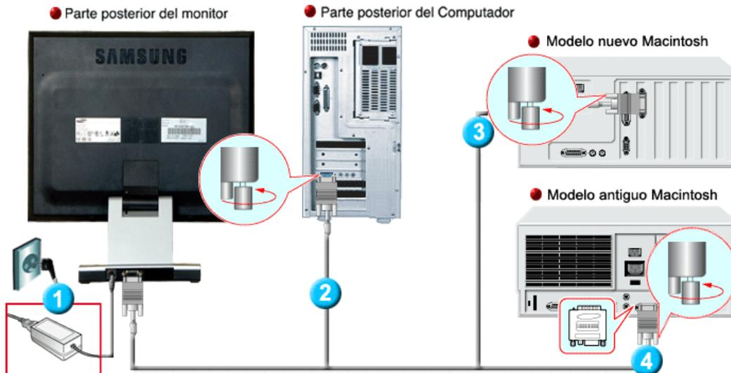
1. Conecte el adaptador DC del monitor en la conexión eléctrica de su parte posterior. Enchufar el cordón de suministro eléctrico del monitor a un tomacorriente cercano.
