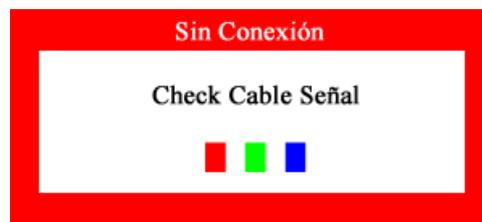
La ausencia de una de las cajas indica un problema en el monitor. Esta caja también aparece durante la operación normal si el cable de video se desconecta o se daña.
