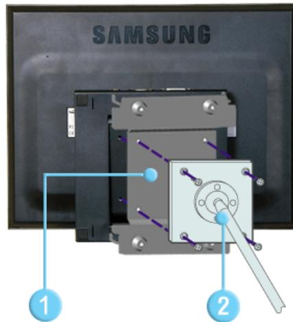
Presione la base plegada del monitor sobre el soporte de montaje VESA. Entonces, sujételo usando las cuatro tuercas suministradas con el monitor, montando alineados la base de montaje y el soporte de montaje VESA.
