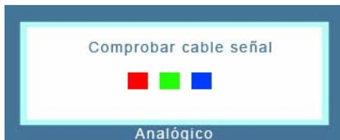
La ausencia de una de las cajas indica un problema en el monitor. Esta caja también aparece durante la operación normal si el cable de video se desconecta o se daña.
